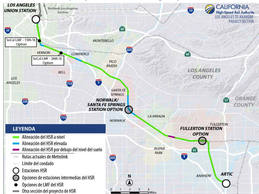
Corredor del tren de pasajeros HSR entre Los Angeles y Anaheim
